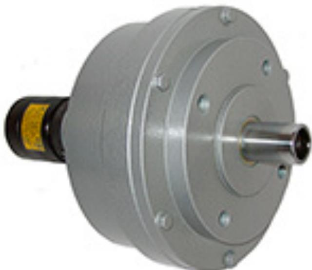
Пневмоцилиндры вращающиеся зажимные предназначены для установки в металлорежущих станках в качестве привода механизированных патронов. Для предотвращения падения давления в полостях цилиндра, при внезапном падении давления в сети, в пневмоцилиндр встроены пневматические клапаны, автоматически отключающие полости цилиндра от сети и обеспечивающие поддержание силы зажим детали в патроне до остановки вращения шпинделя станка.
