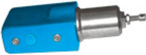
Гидроклапаны давления с обратным клапаном Г66-3, ПГ66-3 предназначены для использования в гидросистемах для пропускания потока рабочей жидкости при достижении заданной величины давления, определяемой настройкой пружины, в этом потоке или управляющем (дистанционное управление). При движении потока в противоположном направлении гидроклапаны обеспечивают его свободное пропускание. Клапаны работают на минеральных маслах.
