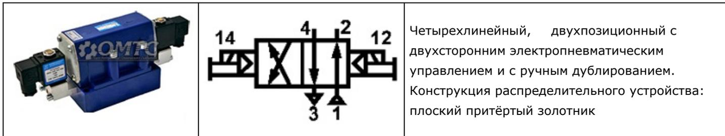
Четырехлинейный, двухпозиционный с двухсторонним электропневматическим управлением и с ручным дублированием. Конструкция распределительного устройства: плоский притёртый золотник
