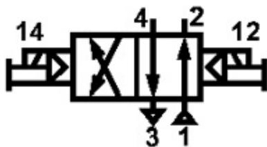
Четырехлинейный, двухпозиционный с двухсторонним электропневматическим управлением и с ручным дублированием. Конструкция распределительного устройства: плоский притёртый золотник
