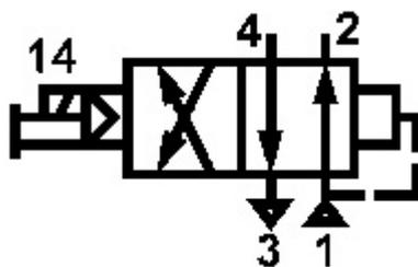
Четырехлинейный, двухпозиционный с односторонним электропневматическим управлением с ручным дублированием и пневматическим возвратом в исходное положение. Конструкция распределительного устройства: плоский притёртый золотник
