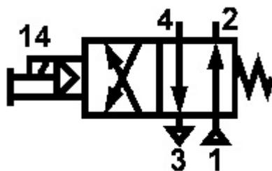
Четырехлинейный, двухпозиционный с односторонним электропневматическим управлением с ручным дублированием и пружинным возвратом в исходное положение. Конструкция распределительного устройства: плоский притёртый золотник
